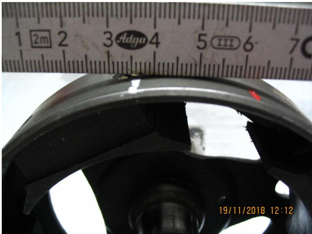
Die Mitte, also 38,5 mm, zwischen den zwei Markierungen ist exakt der obere Totpunkt, den wir nun mit der am Gehäuse angebrachten Markierung deckungsgleich markieren. Am besten markieren wir jetzt den Punkt mit einem Farbklecks, hier in weiß, denn für eine spätere Überprüfung und Einstellung der Zündung wird der immer mal wieder gebraucht. Die Filzstift Markierungen wieder entfernen, da die uns sonst irritieren würden. Jetzt die Kerze mit dem Langgewinde wieder rausdrehen.
