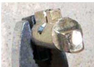
Die Schraube wird nun auf die benötigte Länge abgesägt.
