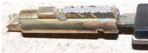
Um ein neues Sperrblech für die Halterung der Federn anzufertigen, schneidet man ein kleines Blech 0.5 mm dick, 3 mm breit und 10 mm lang. Dieses musst man anpassen (feilen) bis es in die U-Führung passt.
