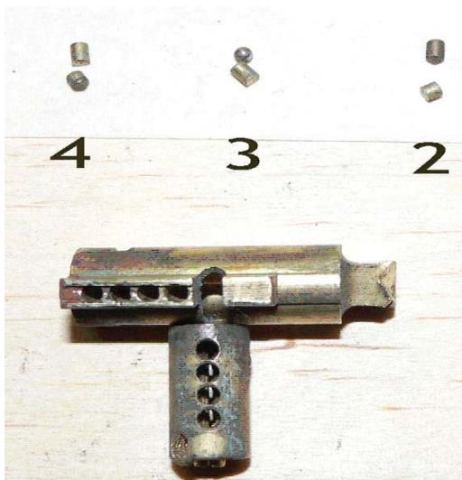
Das Schloss aus der Schraubstock entnehmen und dieses umdrehen. Die Riegel sorgfältig aus den vier Bohrungen herausnehmen und ordnen. Aufpassen in welchem Loch welcher Riegel gehört. Die Riegel könne scharfkantig sein, also aufgepasst!
