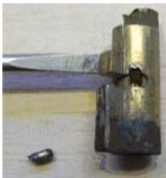
Die kleine, drehbare Achse der Arretierung war leider auch gebrochen. Dies war festgeschraubt im Zylinder (M3). Später wird gezeigt wie eine neue gefertigt wird.
