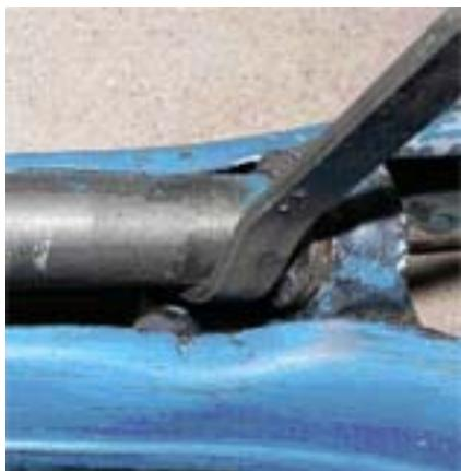
Nach einigen Hammerschlägen auf das Spezialwerkzeug ist das Lenkerschloss vorne rausgekommen.
