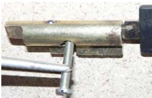
An der Markierung ein etwa 4 bis 5 mm tiefes (nicht tiefer!) 2,5mm Loch bis zur Zylindermitte bohren
