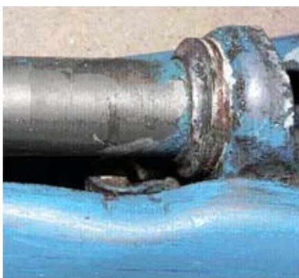
Hier sieht man, zwischen einer Gabelseite und der Lenkungsachse, die hintere Ansicht des Schlosses. Es sieht aus wie ein Viereck aus Messing. Die einzige Möglichkeit ist das Schloss mit einem speziellen Werkzeug herauszuschlagen.
