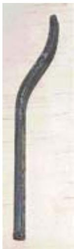
Hier ist das benötigte „Spezialwerkzeug“. Dafür habe ich ein Flacheisen genommen 6 x 10 x 120 mm lang, eine entsprechende Form gegeben und zwischen Gabel Arm und Lenkerachse hingebracht.
