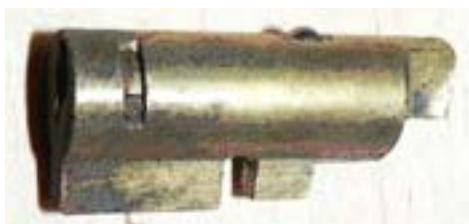
So sieht das ausgebaute Schloss aus. Natürlich ist die hintere Seite vom Schloss durch die Hammerschläge beschädigt worden, aber ohne größere Probleme.
